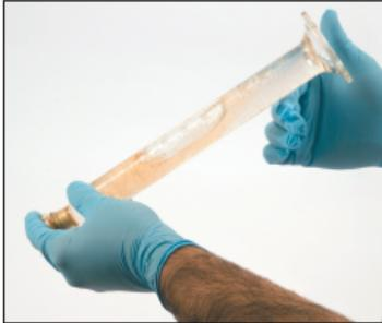
← Tampar e inverter a proveta por pelo menos dez vezes, evitando a agitação enérgica, para completar a extração do etanol para a fase aquosa (etanol na água).
